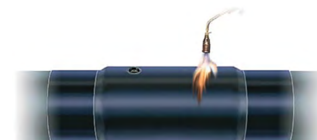
Рис. 17. Розігріти полум'ям протягом 3-5 сек. адгезивний шар латки герметизуючої і накласти її симетрично щодо отвору.
