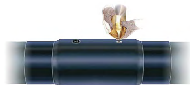
Рис. 15а. Суміш поліолу та ізоціанату швидко влити через заливний отвір муфти.
